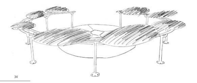
Die Wiedergabegeräte und die elektronische Steuerung befindet sich im abgedeckten Becken in der Mitte. Dafür müsste die vorhandene Abdeckung erneuert werden, damit die Elektronik gegen Umwelteinflüsse und Diebstahl geschützt ist.
