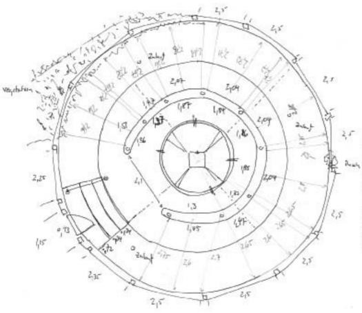
Die Installation wird aus acht gleichen, kreisförmigen Elementen gebildet. Sie bestehen jeweils aus einer Aluminiumscheibe (Stärke: 2 mm) mit einem Meter Durchmesser, unter der sich ein Lautsprecher (-system) befindet. Diese Einheiten sind auf dem Handlauf des Beckens befestigt. Der Handlauf wird von neun Stützen getragen. Dadurch ergeben sich acht ähnliche Kreissegmente, in denen die Objekte platziert werden.
